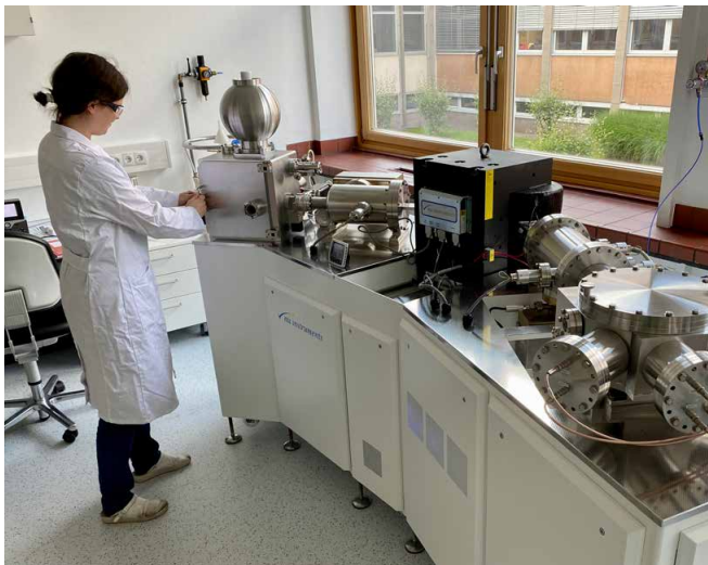
Sara Widhalm und das Thermo Ionen Massenspektrometer (TIMS); Foto: Thomas Meisel, Montanuniversität Leoben
