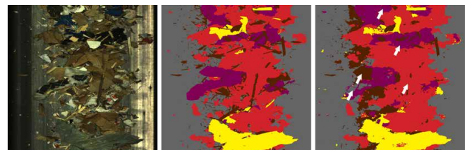
Links ist das Beispielbild des Abfallstroms zu sehen. Die Bilderkennung kann daraus die Abfallklassen erkennen, wie der Vergleich der tatsächlichen (Mitte) mit den erkannten (rechts) Abfallklassen zeigt.
